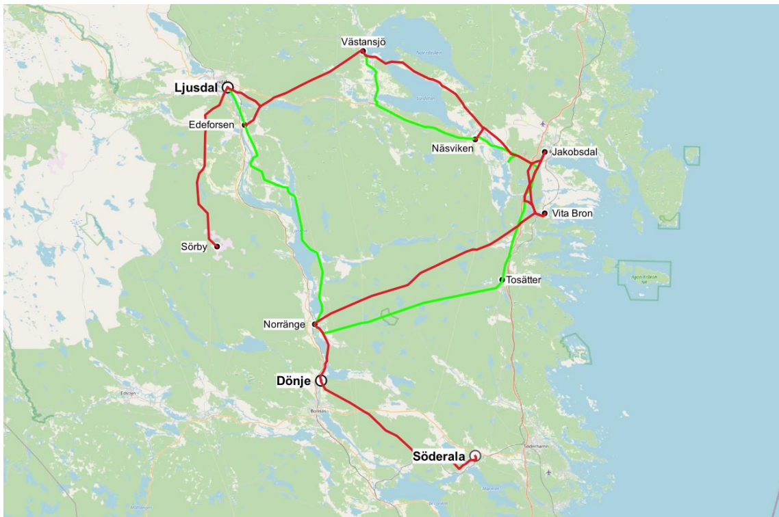
Figur 2. Schematisk skiss över det befintliga regionnätet i östra Hälsingland. De röda linjerna är Ellevios 130 kV ledningar och de gröna linjerna är Ellevios 40 kV ledningar.
