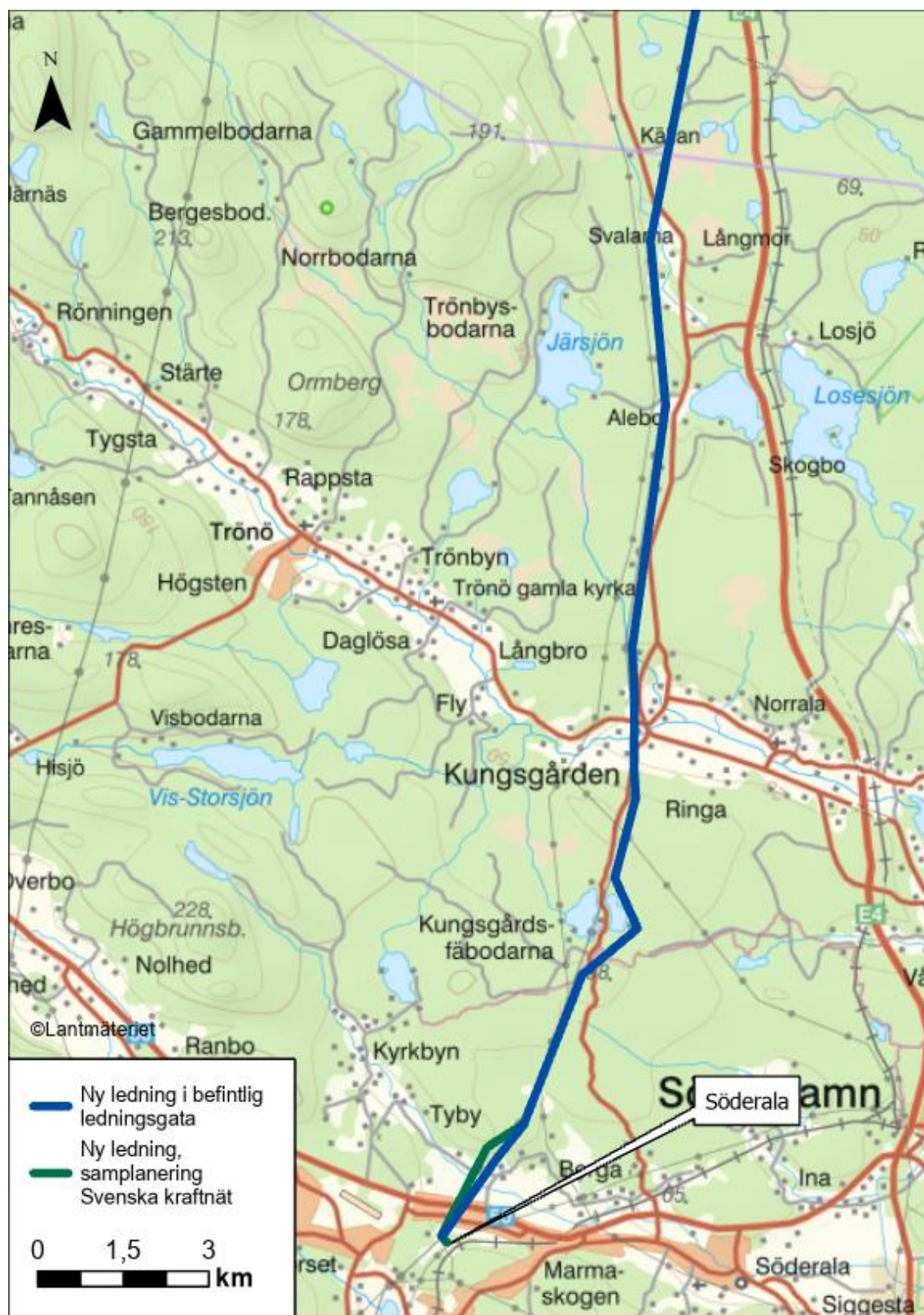
Figur 12. Översiktlig karta över södra delen av ledningssträckningen där ledningen till största del går i befintlig ledningsgata. Vid Kungsgårds fäbodarna avviker planerad sträckning för att undvika närhet till fritidshus.
