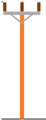
Figur 6. Stolpe för 50 kV ledning
