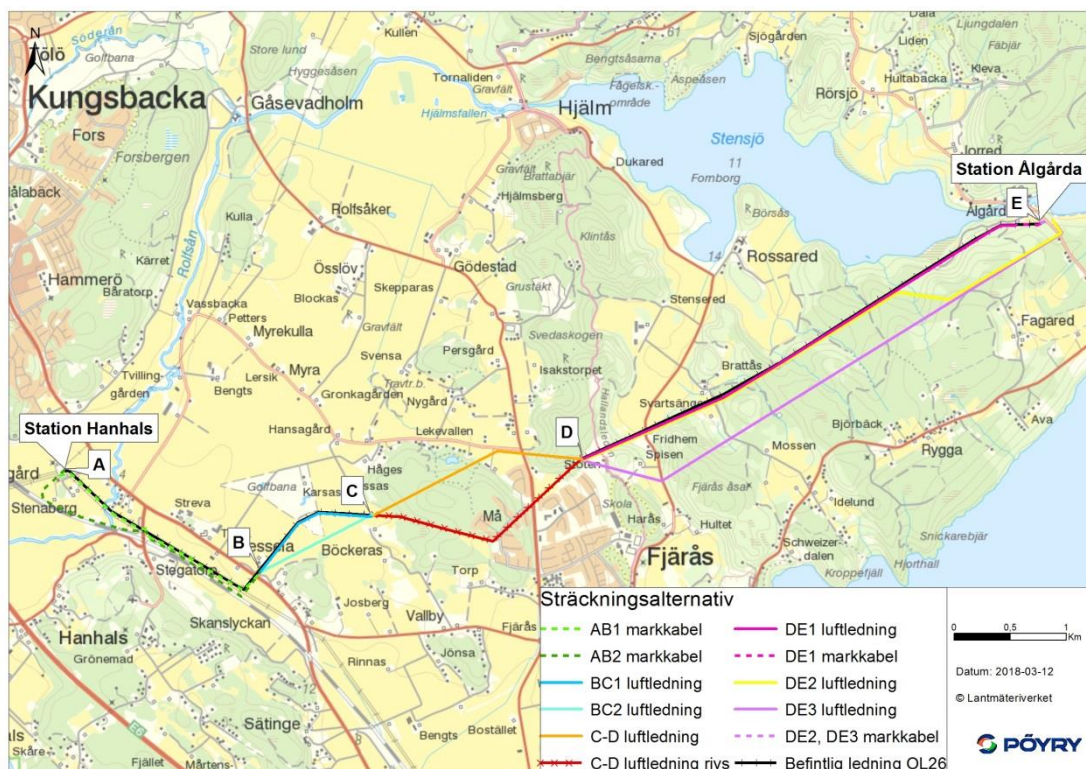
Figur 8 Studerade alternativ till sträckning för ny och befintlig ledning. Mellan A och D berör alternativutredningen både den befintliga och den nya ledningen. Alternativen för sträckan D-E berör enbart den nya ledningen. Den befintliga ledningen står kvar i befintlig sträckning. För mer detaljerade kartor hänvisas till kartbilagorna.
