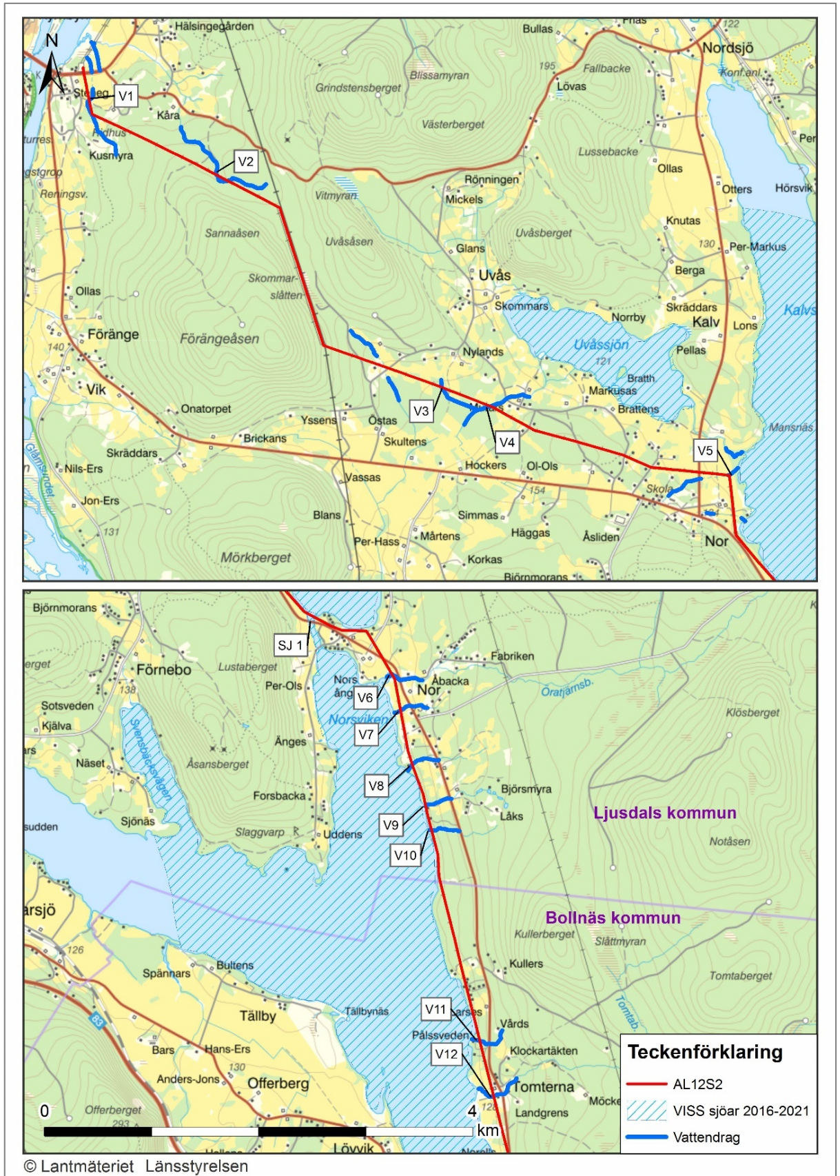
Figur 10. Vattendrag som korsars i luft av befintlig luftledning.
